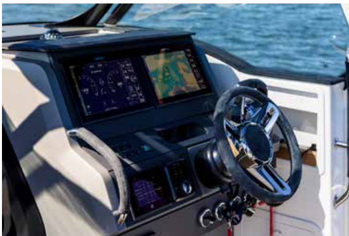
Instrumentpanelen är helt omgjord i T9 och liknar mer T8. Instrumentbrädan har plats för olika kombinationer av kartplottrar: singel 9, singel 12, singel 16 eller dubbla 12 tum.
