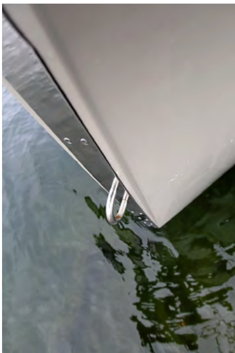
Längs stäven är en skyddande rostfri skena fastskruvad, vilken fredar plasten under mot småstötter och lätta bryggkontakter och även bidrar till ett elegantare utseende // Foto: Joakim Hermansson
