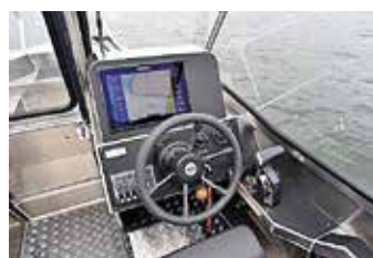
Elegant förarplats med stor plats för kartplotter och instrument. Toppmonterat växelreglage och bekvämt armstöd strax bakom.
