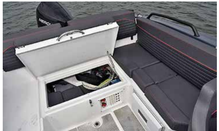
Stuvutrymme i Falcon 8BR. Durken består av plast med förstärkta gångtytor med aluminium. Hybridlösningen med både plast och aluminium är ljus och snygg.
