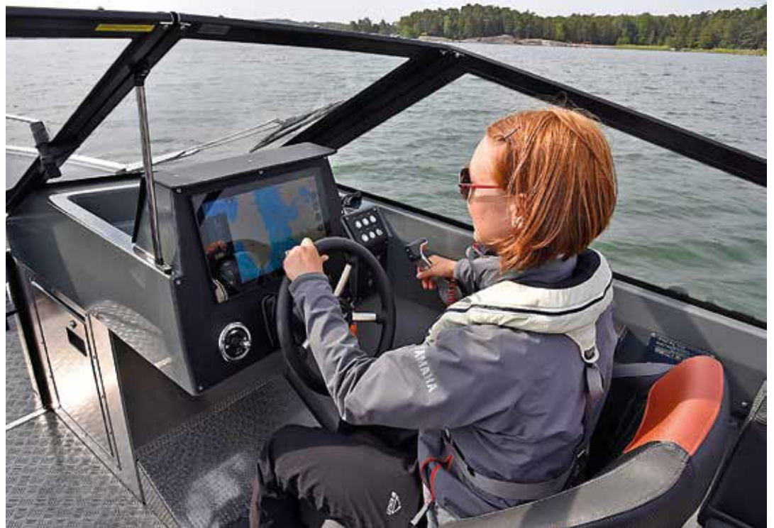
Buster har en förarmiljö med färre brytare och instrument. All navigation och ljud är samlat i deras Q-display.
