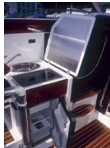
Pentryt, med dubbla kokplattor, diskho och plats för kylskåp är inrymt under passagerarsätet. På den motsatta sidan finns förvaringsmöjligheter i form av lådor.
